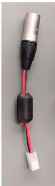
Рис. 1г. Перехідний кабель для підключення блоку живлення до виробу
