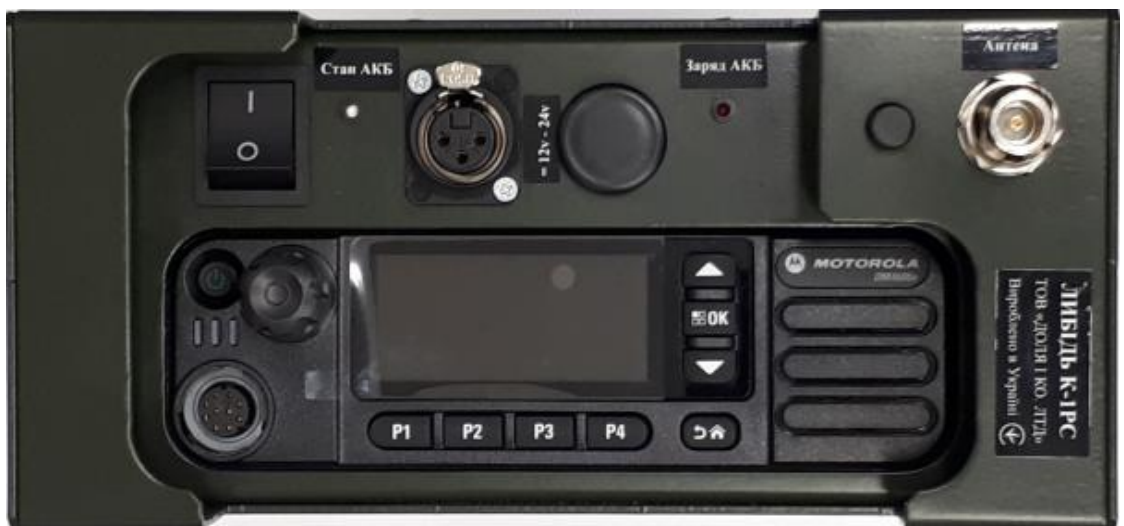
Рис.2а Верхня панель виробу «Либідь К-1РС» (без рознімання «гарнітура» та перемикача примусового вмикання/вимикання вбудованого у радіостанцію динаміка)
