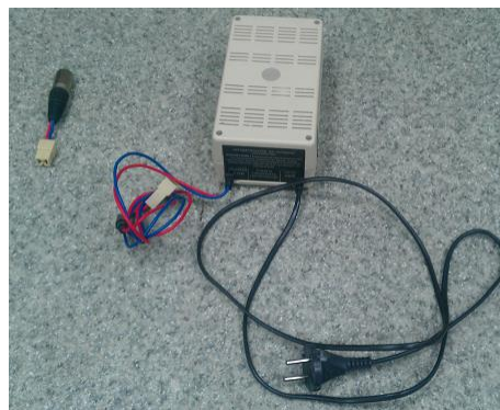
Рис. 1в-1. Спеціальний блок живлення і зарядки кислотних акумуляторних батарей (до 2017 року)
