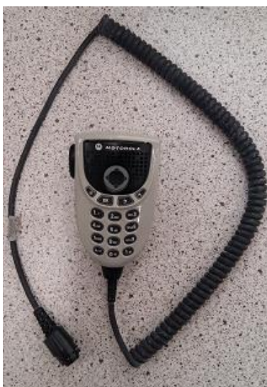
Рис. 1п. Виносний мікрофон з DTMF клавіатурою і тангентою РТТ
