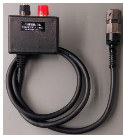
Рис. 1о. «Либідь ПК» - пристрій для підключення до виробу телефонного апарату типу ТА-57
